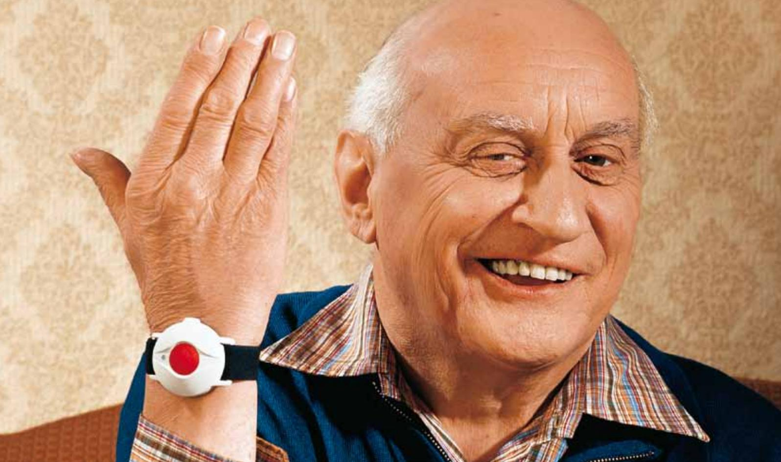
Wenn Sie alleine zu Hause oder am Arbeitsplatz sind, telefoniert **TeleAlarm®S11** auf Knopfdruck um Hilfe. Die Basis passt an jede gängige Telefonsteckdose. Das Notrufsystem wählt unter acht gewünschten Nummern, bis jemand erreicht wird. Weitere Auskünfte: **Swisscom Shop**, [www.swisscom-fixnet.ch](http://www.swisscom-fixnet.ch), **Gratisnummer 0800 800 800**.
